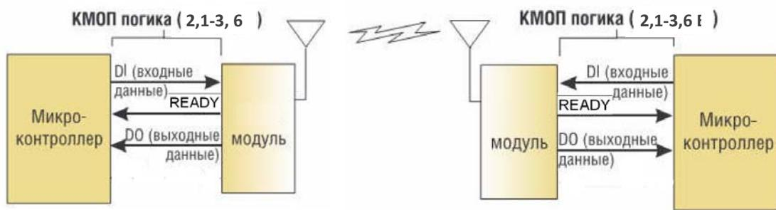
Рис. 2.1. Схема подключения двух модулей для организации канала
