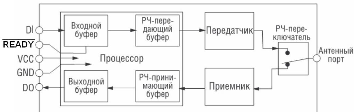
Рис. 2.3. Внутренняя структура модуля EMSee
